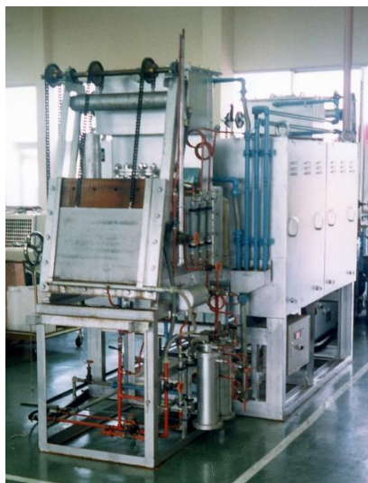
久喜工場第二棟雰囲気電気炉 (昭和55年)
